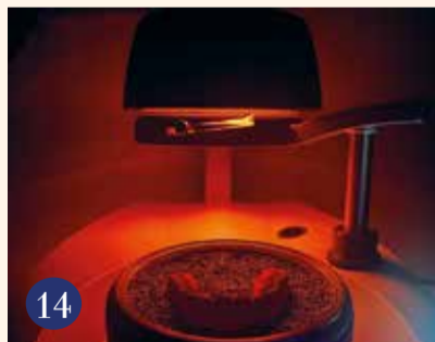
Slika 14. Zagrijavanje elastične folije u aparatu Erkoform 3D+.
