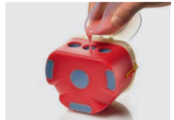
12. Pour the resin into the central pouring channel
