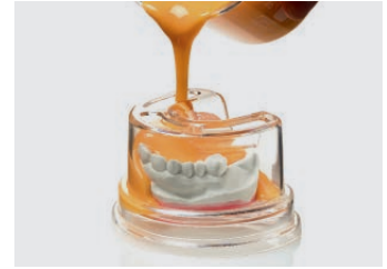
4. Pour Elite Double 22 into the flask
