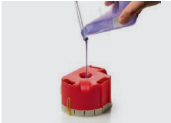
5. Pour Elite Double 16 into the flask
